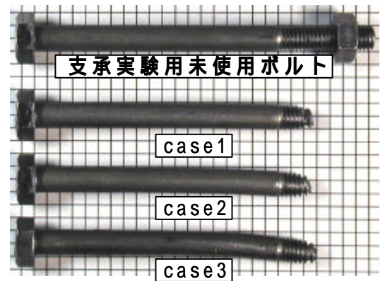
図-8 後列側ボルト破壊状況 (1目盛り5mm)
