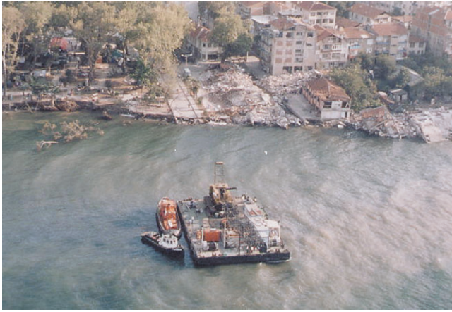
写真-2 トルコ・コジャエリ地震ですべり破壊を生じたデルメンデレの海岸
