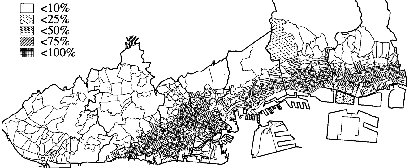
図-1 町丁目ごとの家屋、建物の倒壊率分布(1, 2階および3階以上の家屋、建物の大きな破損)
