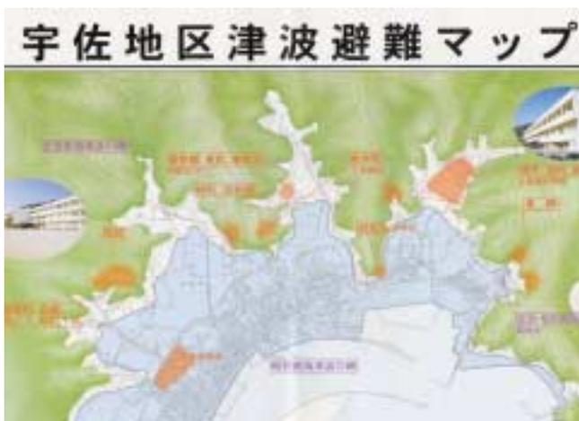
図-3 高知県土佐市宇佐地区津波避難マップ（避難所と津波モニュメントを併記した津波氾濫図。この地域は過去の南海地震津波で大きな被害を受けている。津波ハザードマップはこれを基礎にして作られる。）
