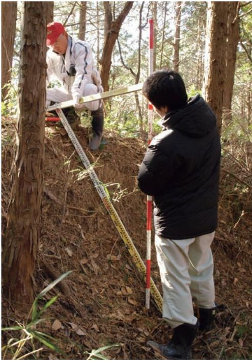
写真1 段築法面の勾配測量(7分勾配)
