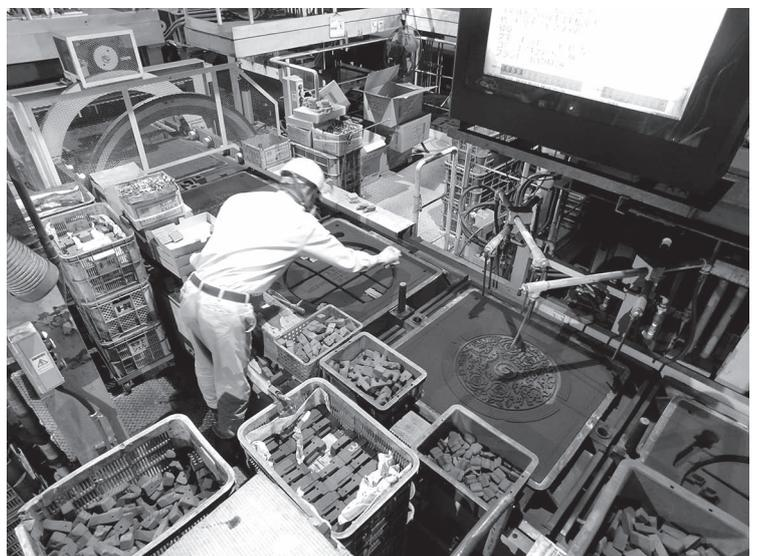
写真1 自動造型機によりつくられた砂の鋳型
