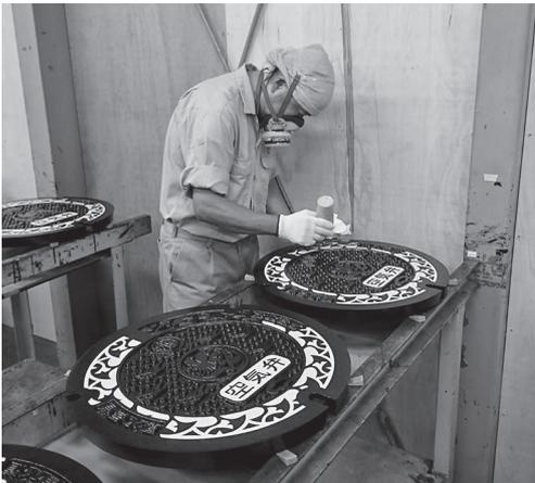
写真2 さび止め塗布後の専門の職人による色付け
