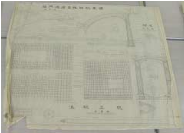
発見された設計原図（稚内港屋蓋鉄筋配置図）
