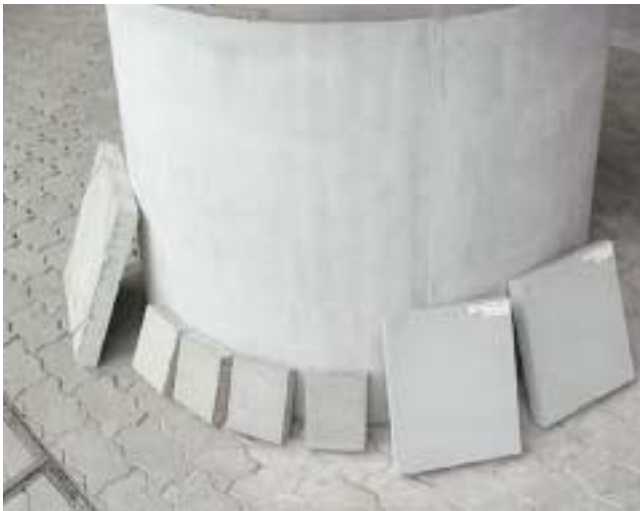
既存のドームと違和感が生じない、色合いや質感になるようにセメントの配合を調整した。
