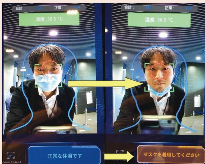
写真1 体温計測のサーモカメラ(左:マスクあり、右:マスクなし、警告が出る)
