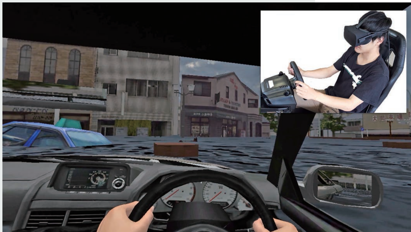
写真1 津波体験ドライビングシミュレーター（提供：愛知工科大学 工学部 板宮朋基教授）
