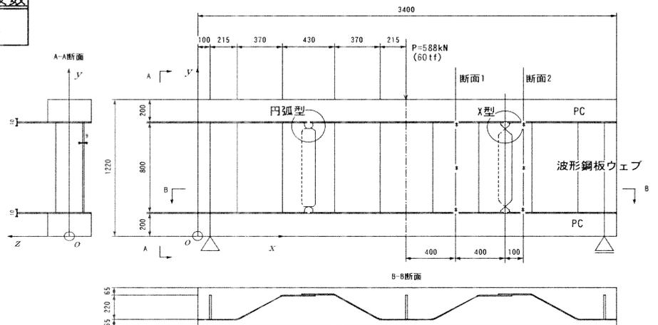
図-2 試験供試体概要
