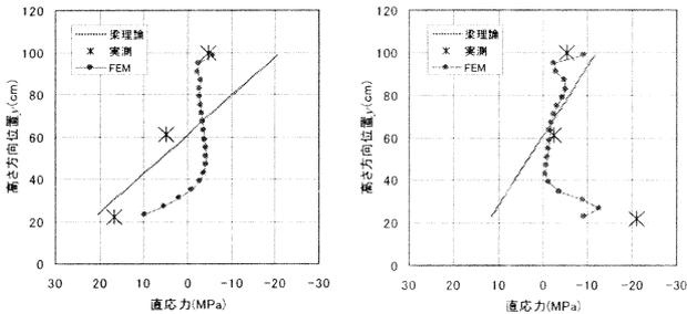
図-3 直応力分布(左:断面1 右:断面2)
