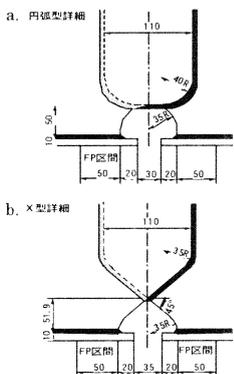
図-1 試験供試体のスカラップ形状
