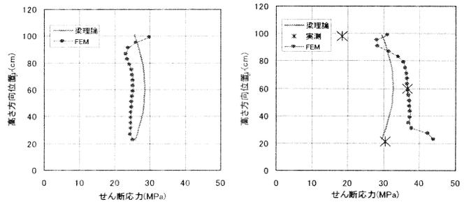
図-4 せん断応力分布(左:断面1 右:断面2)
