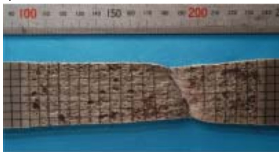
写真 試験片破断状況（60 サイクル腐食試験片）
