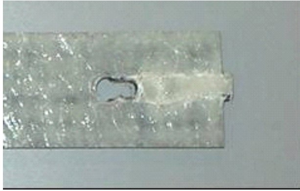
図 II.c セン断破壊の例 8) (図 II.b の b))
