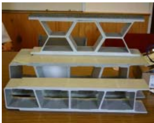
写真 3.3 FRP 床版用引き抜き成形材
