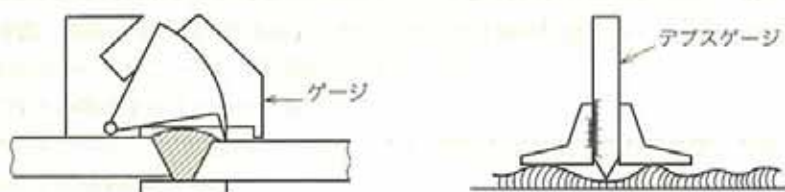
a) 溶接ゲージによる 目違いのチェック
