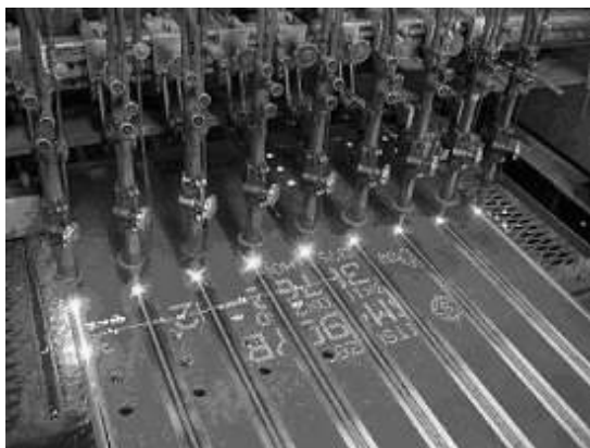
写真-解 3.4.1 ガス切断状況
