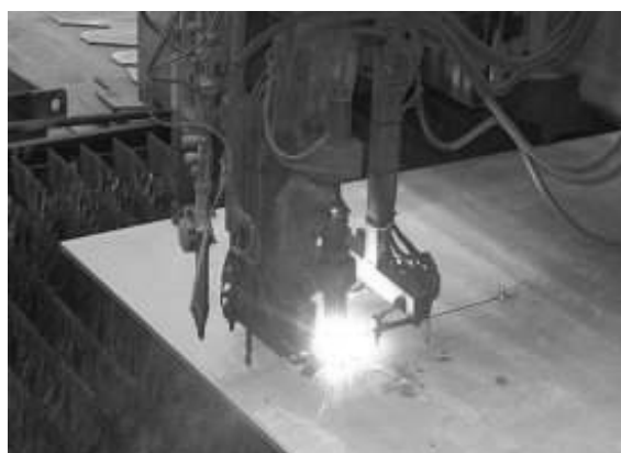
写真-解 3.4.2 プラズマ切断状況
