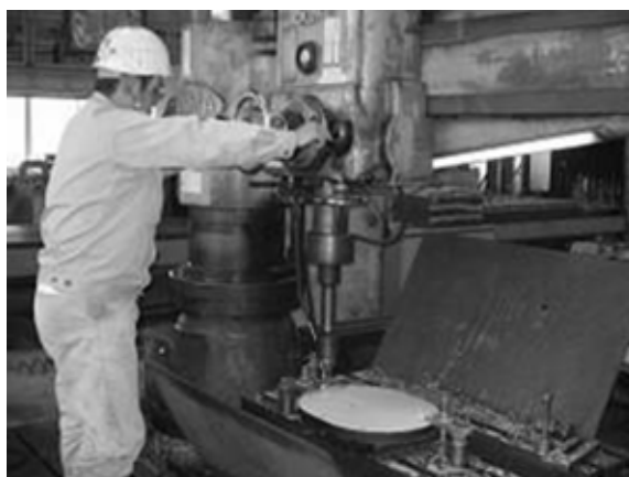
写真-解 3.5.2 ボール盤での重ね明け
