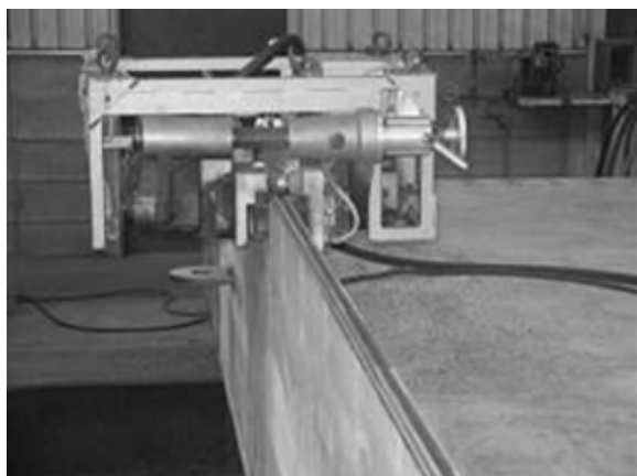
写真-解 3.4.4 簡易型R面取り機
