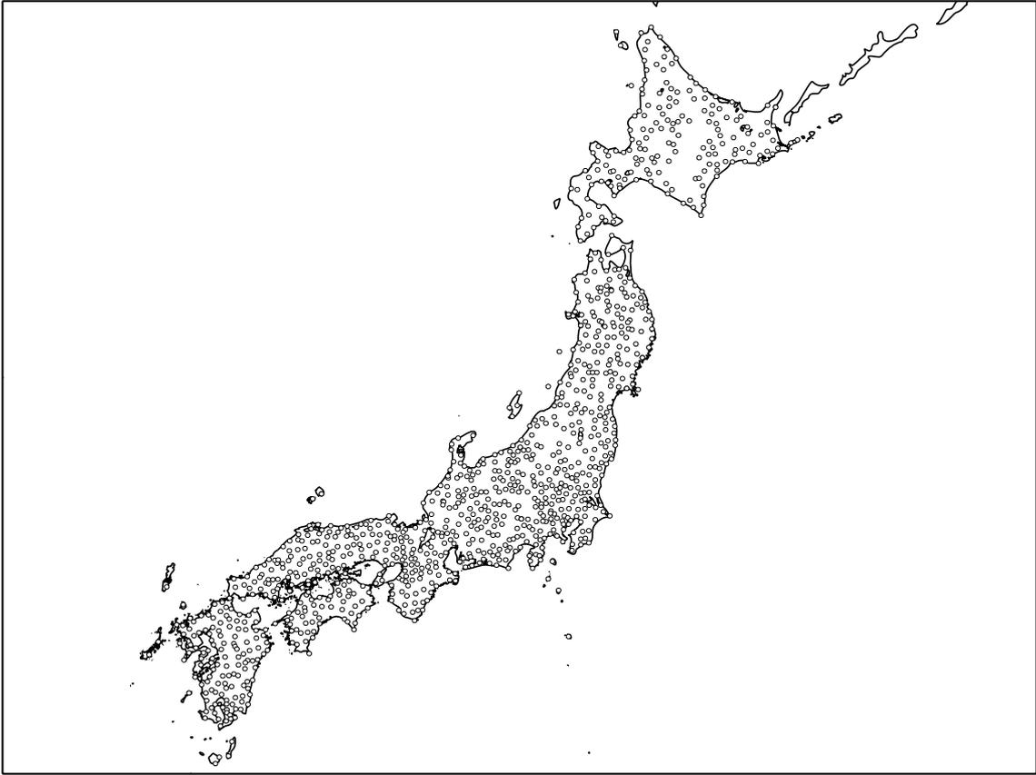
参图 3 最大日降雨量の確率降雨量マップ作成のために選定された地域気象観測所 (1088 箇所)
