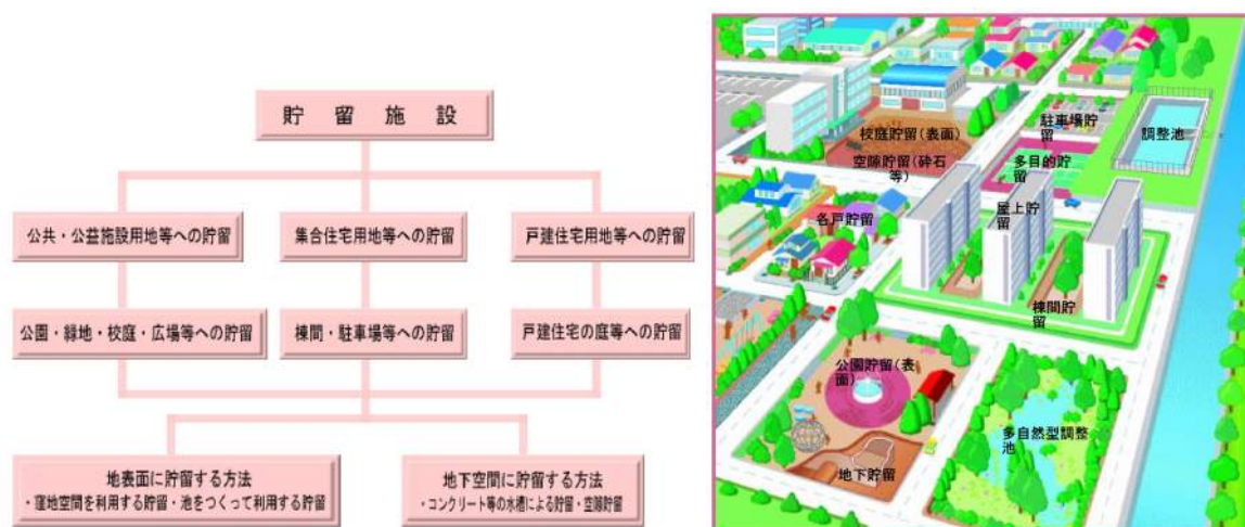
図-4.5.19 雨水貯留施設 9)
