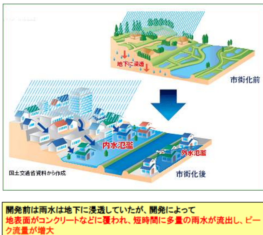
図-4.5.1 市街化による水害発生メカニズム
