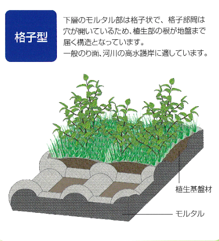
図-4.14 マチュラルグリーンマット （太陽工業）【適応流速 3m/s】
