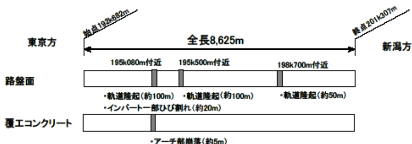
図-4.1.37 魚沼トンネル全体被害状況 12)
