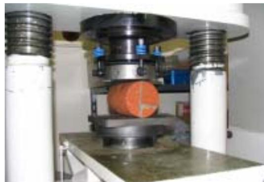
図 11.6.2 採取コアの割裂引張り試験状況
