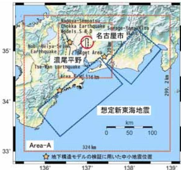
図3 想定地震の断層面と地下構造のモデル化範囲
