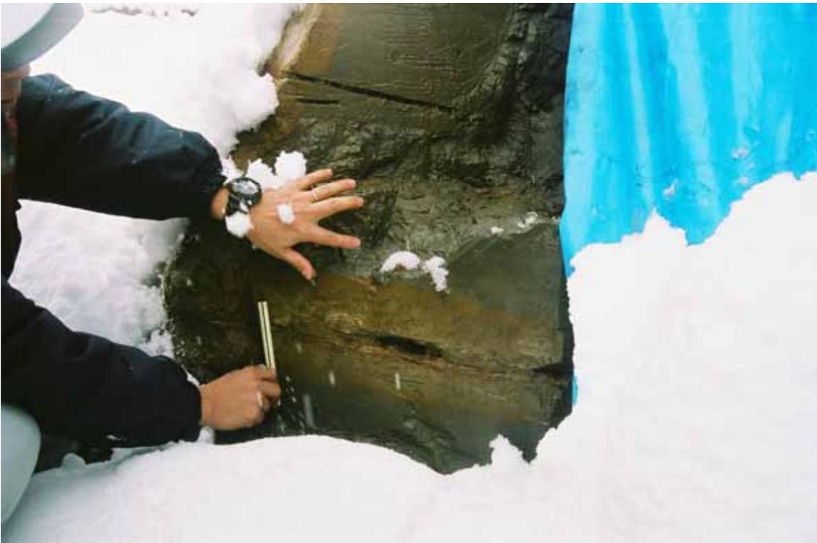
12/11 国道 291 号沿いの岩盤崩壊(47) すべり面の状況
