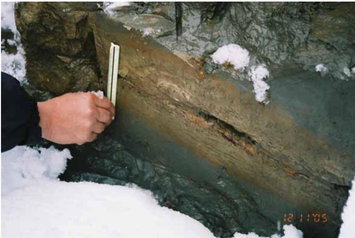
12/11 国道 291 号沿いの岩盤崩壊(47) すべり面（シルト層内）の状況
