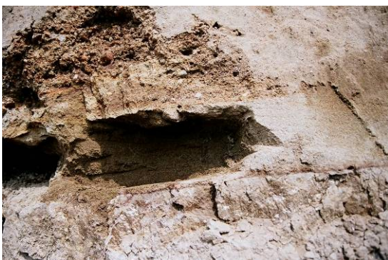
写真 4.24 凝灰角礫岩と礫層(最上部)の境界 礫層の境界付近は鉄分が沈着した砂層 (掘り取った層が砂層である, 受盤)
