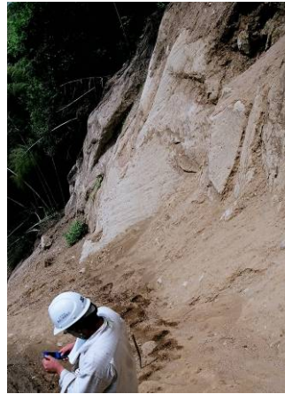
写真 4.21 崩壊地上部の凝灰角礫岩の露頭 節理を境にさび状に岩塊が崩落。 露頭に岩塊が移動した痕跡が残っている。
