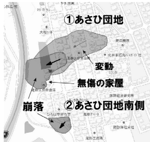
図3 あさひ台団地の変動盛土ユニット
