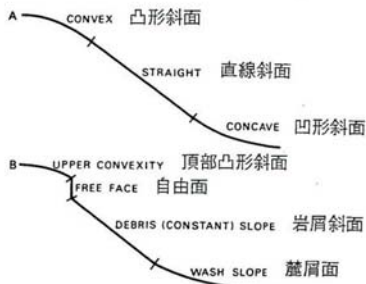
図 14.0.4 3 区間複式斜面 (上) と 4 区間複式斜面 (下) の基本的類型 (Chorley et al., 1984, Fig. 11.2)
