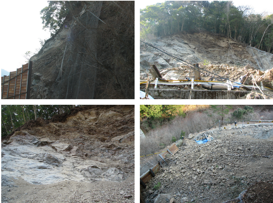
写真-2. 崩壊内部の写真. 左上: 北から南を見上げる. 右上: 崩壊を正面から見上げる (左半分に白く見える節理面が露出し, その上に褐色化した割れ目に富む岩盤が載る). 左下: すべり面となった湾曲した節理面とその上の褐色化した岩盤. 右下: 崩壊上部から堆積物を見下ろす.
