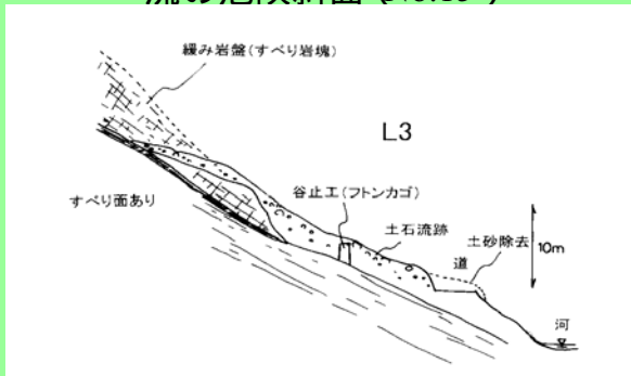
図-5 岩盤地すべりと沢沿いの土石流の危険斜面 (No.15)
