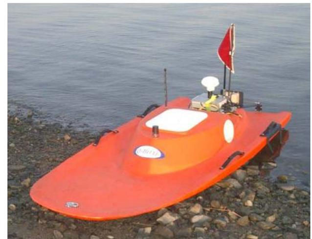
ADCP搭載型ラジコンボートによる観測状況
