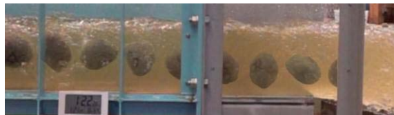
図-5 流速約 8m/s の流況(上)と高速撮影した礫の流下状況(下)
