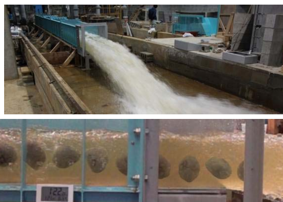
図-5 流速約 8m/s の流況 (上) と高速撮影した礫の流下状況 (下)
