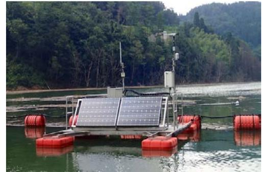
図-1 殿ダム貯水池の気象観測装置
