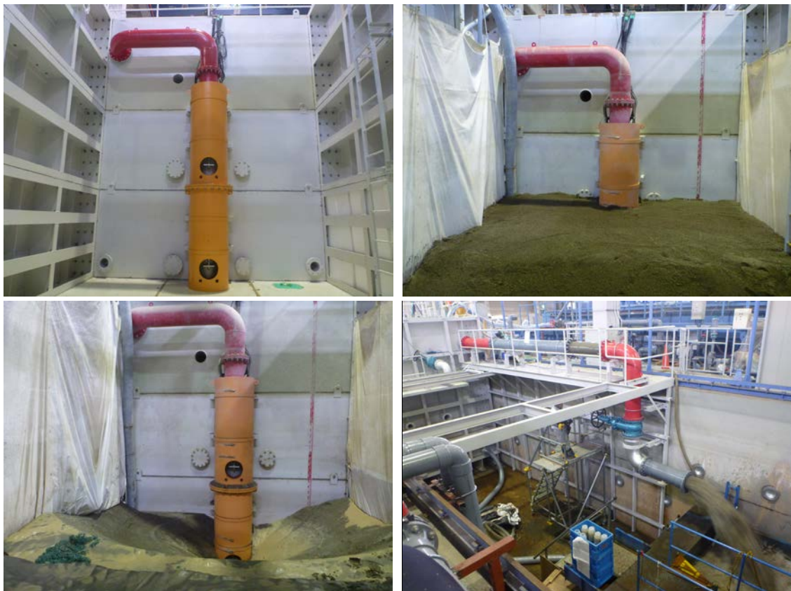
写真-2 プロトタイプシステム設備と土砂の吸引実験状況
