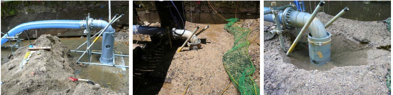
写真-1 鉛直二重管吸引工法の模型実験の状況（左：設備設置、中：実験前、右：実験後）
