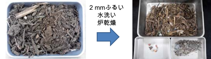
手作業選別による廃棄物含有率試験
