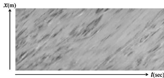
図-4 流下方向の画像輝度の時空間分布<sup>2)</sup>
