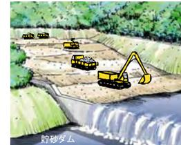
土砂を貯砂ダムによってダム湖に流れ込む前に貯めた後、取り除きます。
