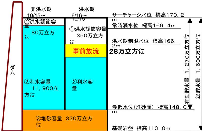
平成17年台風14号において、野村ダムは事前放流として約28万m<sup>3</sup>の容量を確保。野村ダムの洪水調節容量は350万m<sup>3</sup>であり、この28万m<sup>3</sup>が無ければ、水位はサーチャージ水位に到達し、ただし書き操作を実施していたところ。洪水調節容量の約1割弱の事前放流ではあったが、洪水調節を実施する上で大きな効果を発揮。
