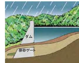
洪水時に水の利用してダム湖に溜まった土砂を水とともに下流へ排砂します。
