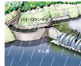
洪水時に、バイバーストンネルにより土砂を迂回させダム下流へ流します。
