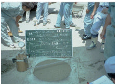
フライアッシュ高流動コンクリート
