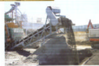
ジェットバック車で運ばれた「Fドライ」と高含水比不良土が混合されて改良土となります。
