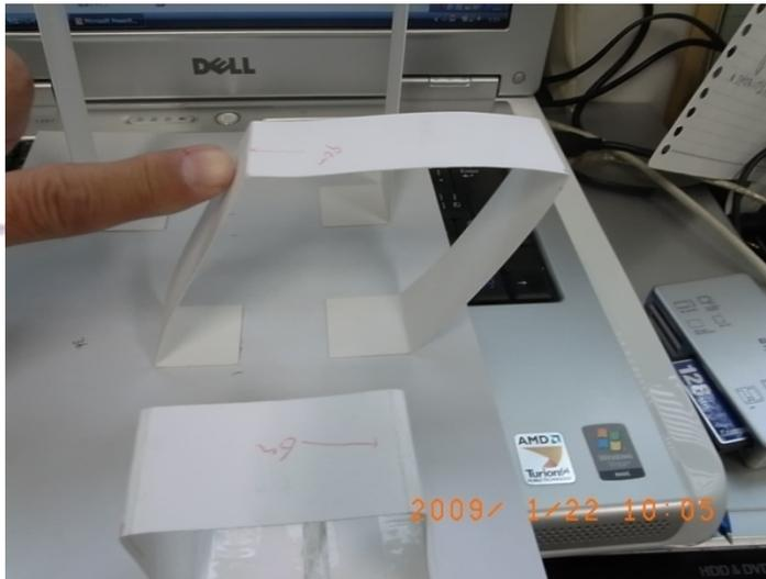
今回のように左右に振る速さを変えてきょうしん点を知る方法の他にもあります。1つのビルの上の方を指で押します。そしてパツとはなします。1, 2回ゆれますが、1往復する時間がビルの固有周期です。この時間でビルをゆすってやればきょうしんします。
