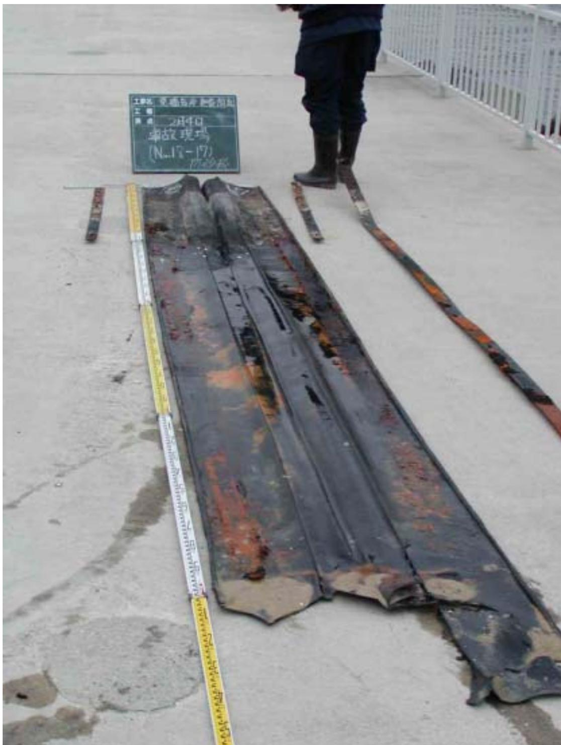
写真 2-3 事故個所の防砂板亀裂発生状況
