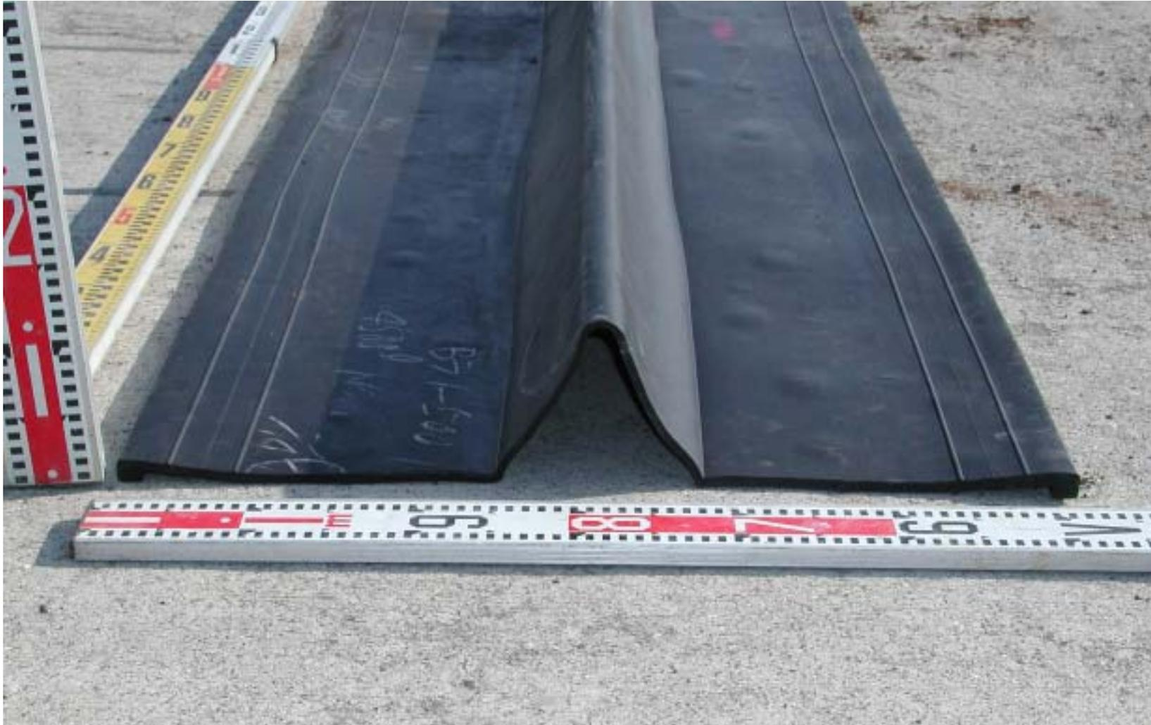
図 2-4 防砂板取り付け状況
