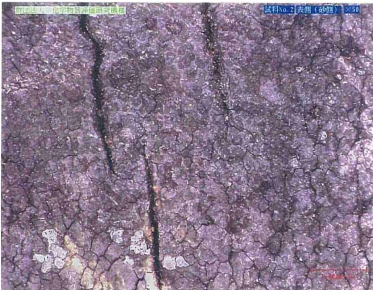
写真 2-6 ケーソンNo. 11-12 防砂板表面の拡大写真(陸側表面 平均海面付近)
