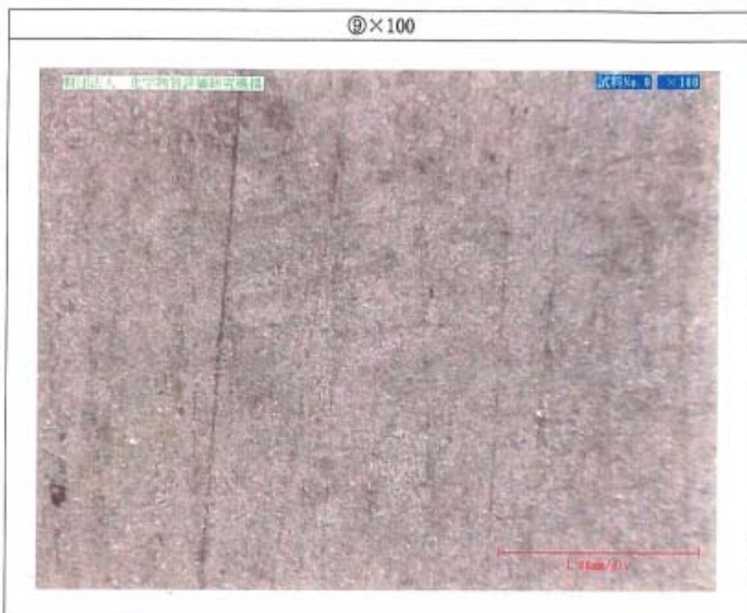
防砂板の侵食深さのデジタルマイクロスコブによる写真
