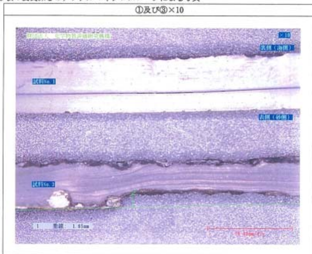
防砂板の侵食深さのデジタルマイクロスコブによる写真
