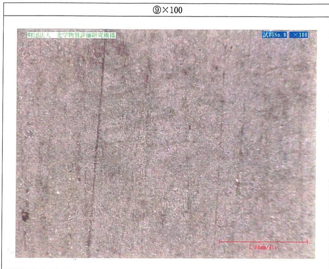
防砂板の侵食深さのデジタルマイクロスコープによる写真
