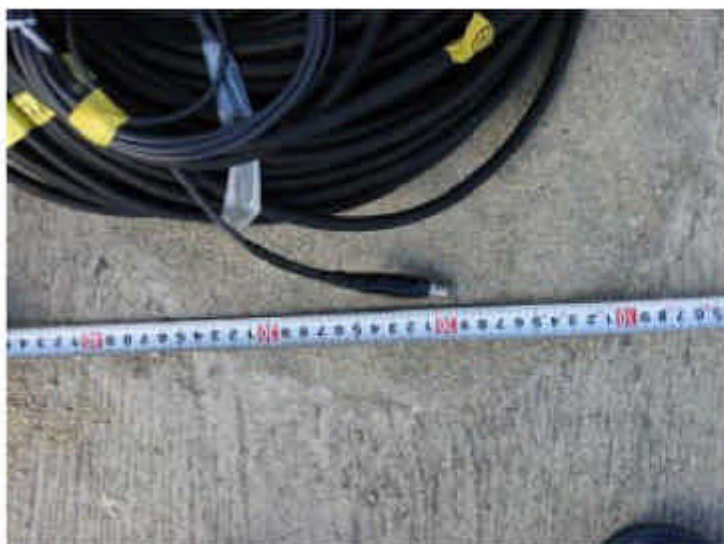
水位計のセンサー部
