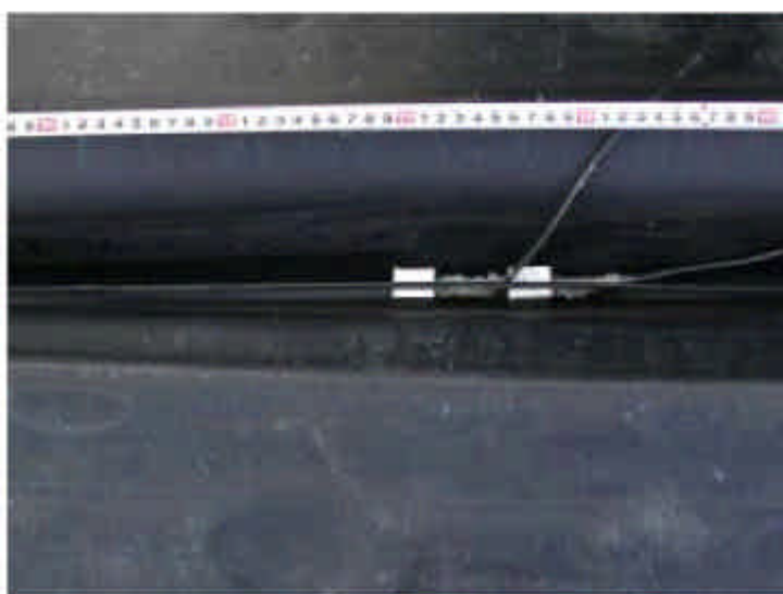
防砂板への 加速度計の取付状況
