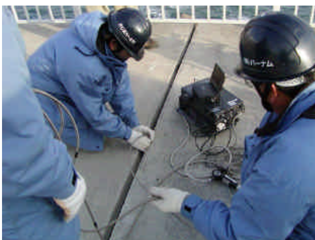
写真－3.1 ファイバースコープによる空洞内部調査 状況写真
