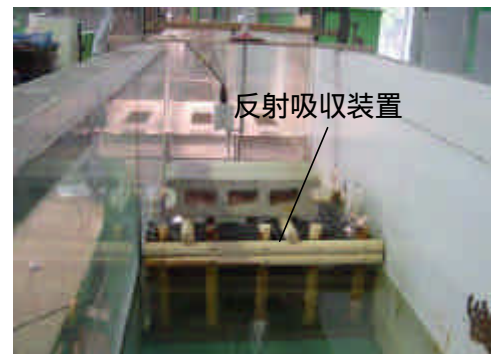
写真 - 3.19 実験装置（反射吸収装置）
