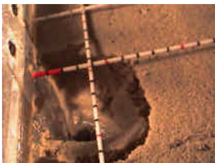
写真 - 3.23 空洞の側壁 (Case5)
