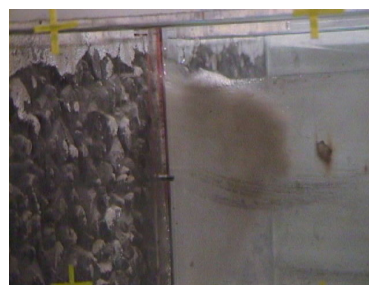
写真-3.21 砂の流出 (Case3)
