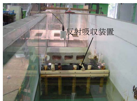
写真－5 実験装置（反射吸収装置）
