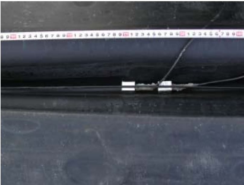
防砂板への 加速度計の取付状況
