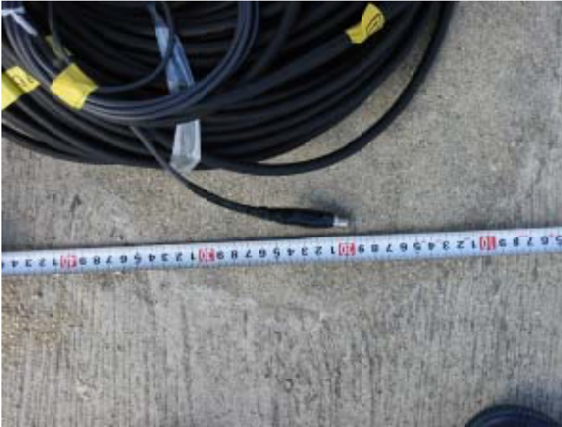
水位計のセンサー部
