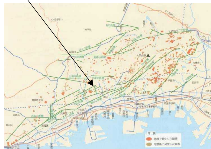
兵庫県南部地震による崩壊箇所図
