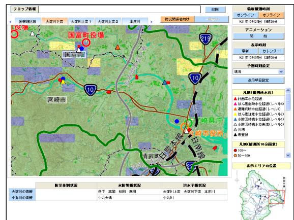
画面-1 全観測所雨量、水位実況・予測結果監視画面
