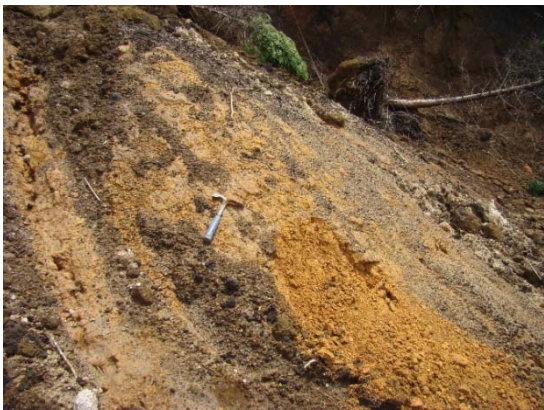
写真 4.3.24 下位の草千里ヶ浜降下軽石 * 上位の軽石層に比べて軟質で含水比も高い
