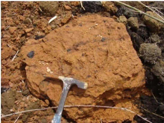
写真 4.3.22 岩の部分の拡大写真 * 風化変質した火砕岩で新鮮な黒曜石核を混じえる。草千里ヶ浜溶結火砕岩？
