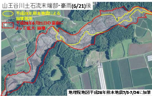
写真 4.4.12 山王谷川の豪雨時の土石流の氾濫域の拡大状況
