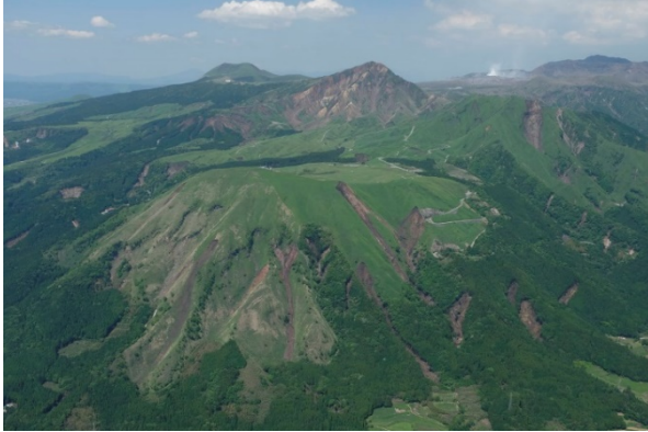
写真 4.3.49 夜峰山南側斜面の崩壊状況 (地震後(5月14日))(撮影：鳥井真之氏)
