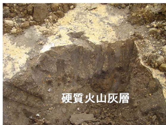
写真 4.3.20 下位の硬質火山灰層に圧砕された軽石の状況
