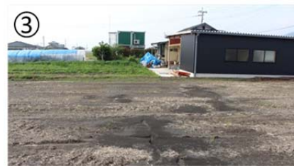
図 3. A. 11 沖新町地区、小島新町地区における液状化被害
