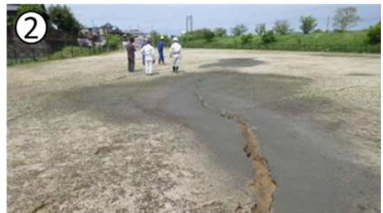
図 3. A. 11 沖新町地区、小島新町地区における液状化被害
